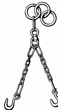
Рис. 101. Engine lifting hook, motor lifting hook крюк для подъема двигателя.
