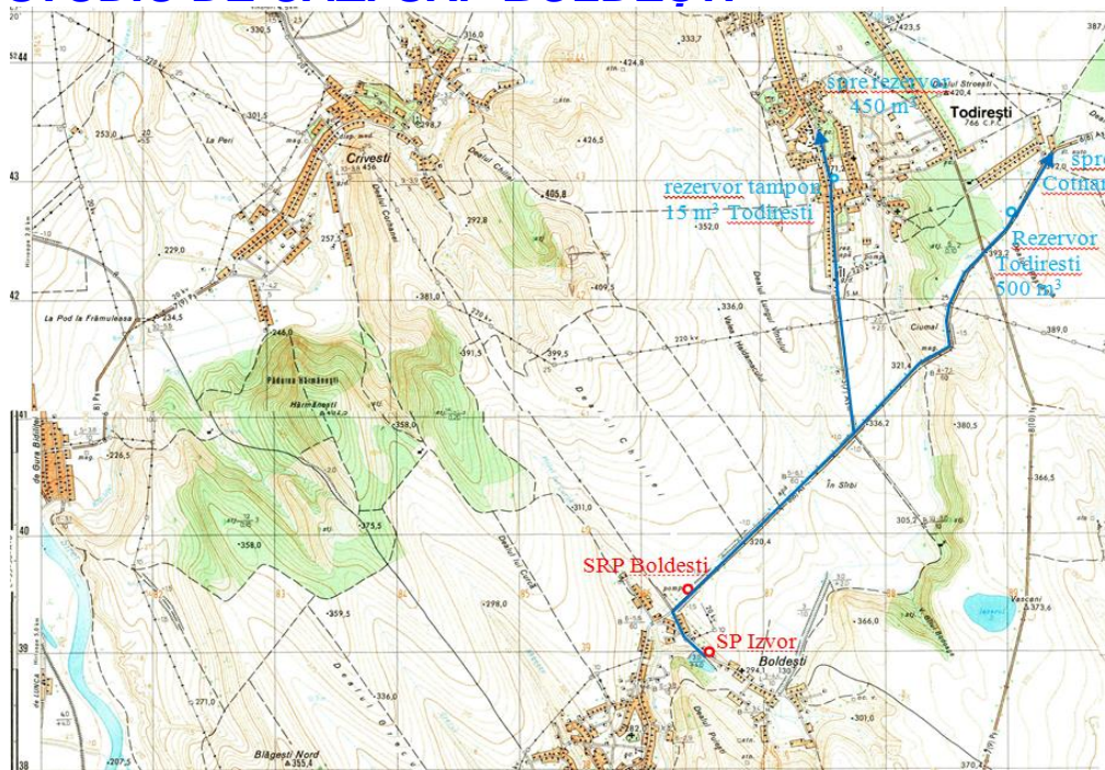
Fig. 4.1. Planul de situație al aducțiunii SP Boldești – SRP Boldești – rezervor Todirești
